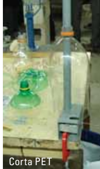
Con el uso de herramienta de bajo costo se produce hilo de pet y se arreglan equipamientos como viejas sillas
