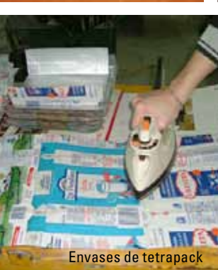
Membrana planchada para aislación hidrófuga
